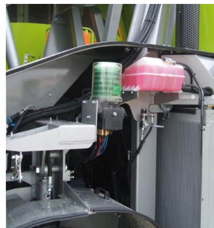
Ingrassaggio centralizzato Automatic centralized greasing
